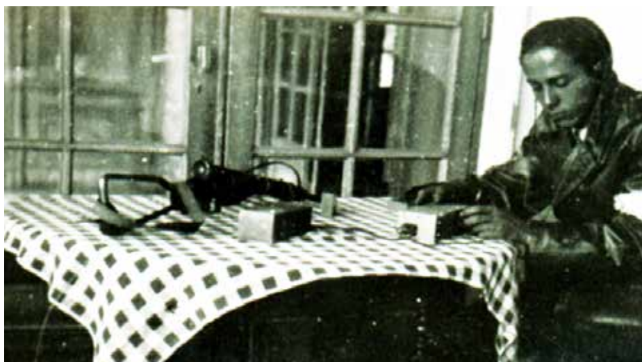
Un résistant écoute une émission de la BBC diffusée « en l'air » (sans possibilité d'échange entre émetteur et récepteur) grâce à son récepteur britannique type MCR 1. Cet appareil miniaturisé, parachuté à la fin de l'occupation, était appelé récepteur « biscuit », du fait qu'il était conditionné dans une boîte en fer blanc de biscuits contenant notamment un casque, une antenne et trois piles. Dans l'hypothèse de coupures de courant (probables dans le contexte du Débarquement), chacune de ses piles offrait à ce poste une autonomie d'écoute de 30 heures en plus de sa possible alimentation par secteur.
