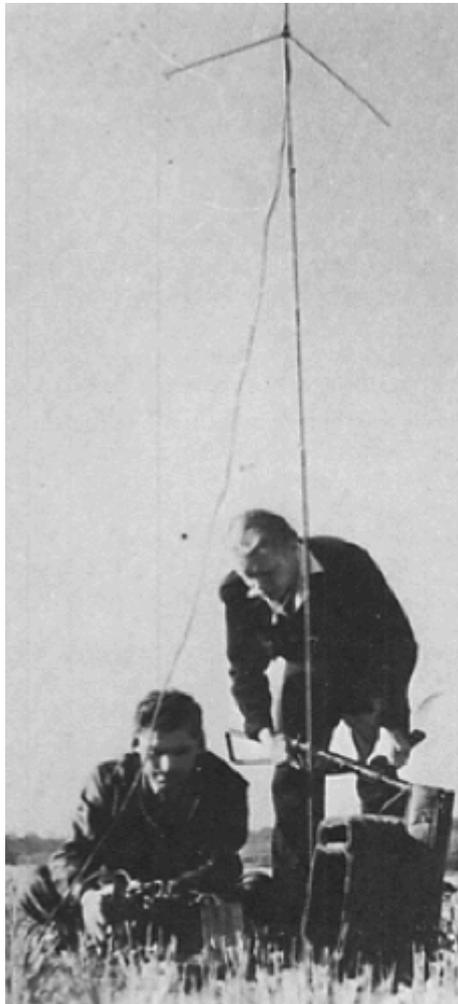
Les premiers appareils parachutés sont volumineux et lourds, contenus dans une caisse en bois. Ensuite l'ensemble du poste tiendra dans un étui de toile molletonnée muni de bretelles et portable sur le dos comme un sac de montagne. Il est alimenté par une batterie d'accumulateurs. Un mât de quelque 3 à 4 mètres de haut porte une antenne à trois branches.
