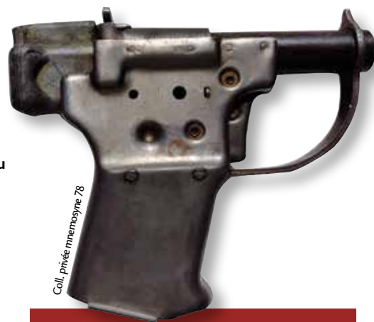
Pistolet américain FP-45 /M1942 Model 3 dit Liberator , face droite avec culasse fermée.
